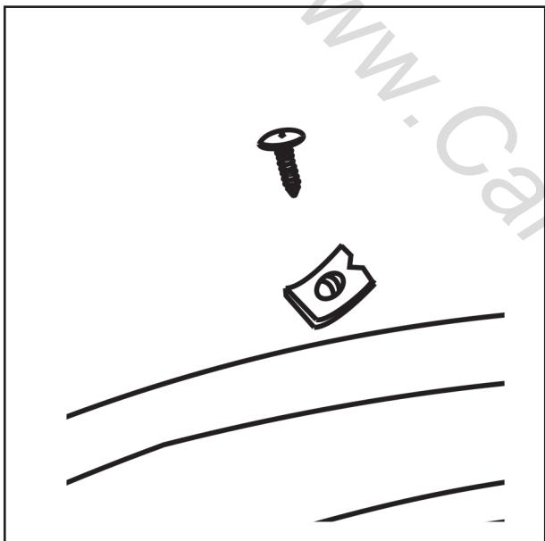
در شکل روبرو نمونه ای خار فلزی و پیچ آن مشاهده می شود.
