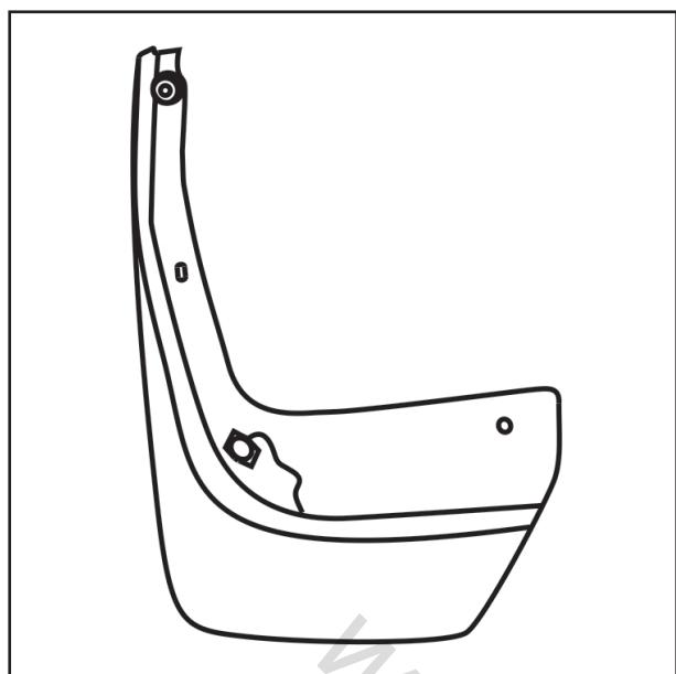
**توجه:** گل پخش کن جلو نیازی به سوراخکاری ندارد ولی در گل پخش کن عقب می بایست با لبه سپر عقب سوراخ و با پیچ خودکار محکم شود.
