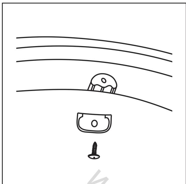
در شکل رو برو نمونه‌ی پیچ و پین مادگی همراه با سوراخ تعییه شده بر روی فول فلاپ مشاهده می‌شود.
