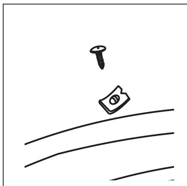
در شکل رو برو نمونه‌ی خار فلزی و پیچ آن مشاهده می‌شود.
