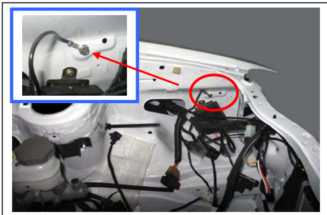
پیچ اتصال بدنه روی آستر گلگیر جلو چپ (پشت منبع انبساط)
