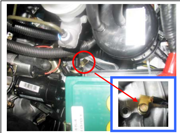
پیچ اتصال بدنه دسته سیم موتور روی پوسته گیربکس
